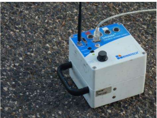
Dynatim® (Centralina misurazione dati)
