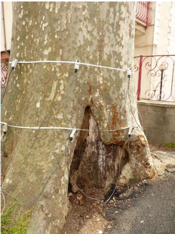
Platano n°82 tomografia sonica al colletto/fusto 3D
