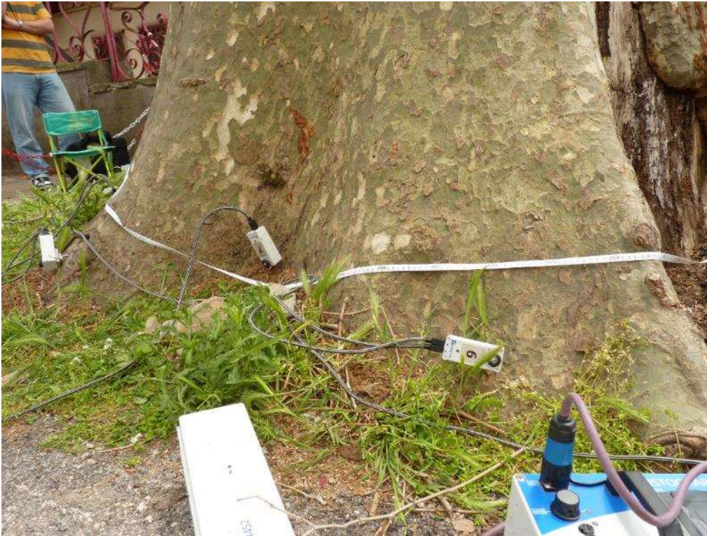
Platano n°82 tomografia sonica al colletto 2D
