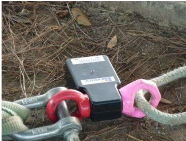
Dinamometro di precisione per registrazione carichi collegato al paranco manuale
